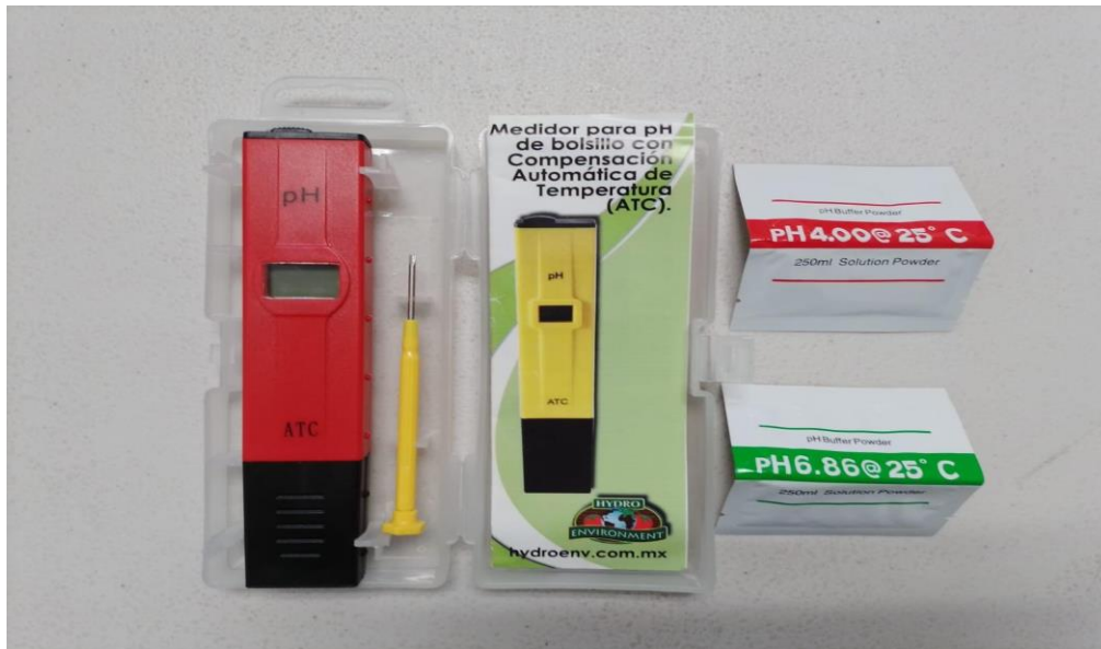
Ilustración 8. Medidor de pH de compensación automática de temperatura (ATC)
